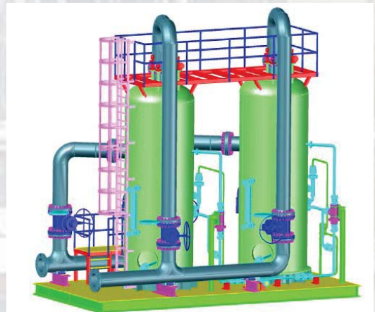
Filtrazione di fuel Gas Enelven - Venezuela
